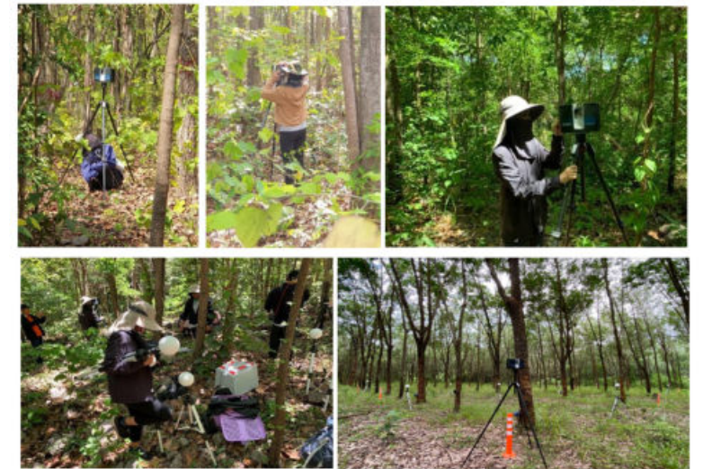
ภาพที่ 3 การเก็บข้อมูลในพื้นที่ป่าธรรมชาติ และสวนยางพาราด้วยเครื่อง TLS ซึ่งต้องคำนึงถึงตำแหน่งของ sphere น้อย 3 ตำแหน่ง ให้สามารถครอบคลุมในแต่ละตั้งของการสแกน
